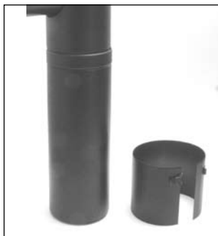
Fig. 3. Montera beklädnadsröret på vinkelanslutningen med spåret på beklädnadsröret uppåt, spänn fast beklädnadsröret med svepet i fig. 1.
