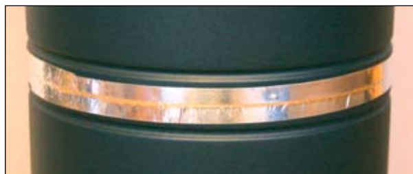
Skarven på beklädnadsröret skall tejpas med aluminiumtapen innan spännbandet monteras. Detta för att förhindra att fukt kan tränga in, och för att undvika otrevlig lukt från isoleringen vid dom första eldningarna.
