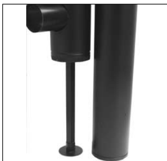
Fig 2. Ställ beklädnadsröret för stödbenet bred vid vinkelanslutningen med den veckade plåtkanten uppåt, markera på beklädnadsröret vart beklädnaden för vinkelanslutningen slutar (se pil). Markera runt beklädnadsröret och såga av detta med en vinkelkap, sticksåg eller bågfil.
